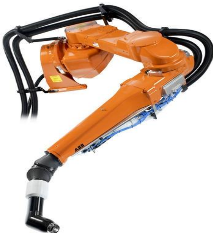
Сурет 2.6 – АВВ фирмасының Flex Painter IRB 5500 өнеркәсіптік кескіндеме роботының сыртқы түрі
